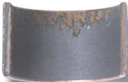
Starke Delamination (Standardwerkstoff)
