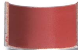
GLYCO® 298 después del ensayo
